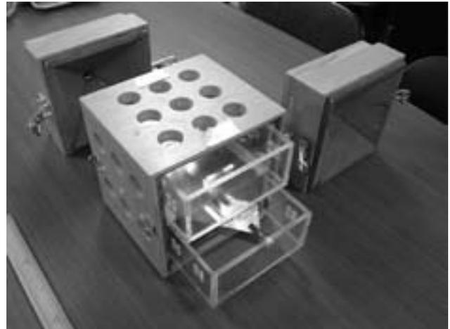
図3 TEM-cell の全体像：Salford らが使用したものと同一規格。彼らは上下2段の亚克力ボックスそれぞれにラットを配置し電波照射をした。
