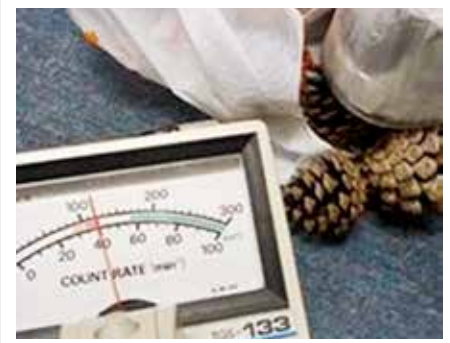
※1: 計測器はGM計数管式で、1分間当たりの放射線の数調べます。
