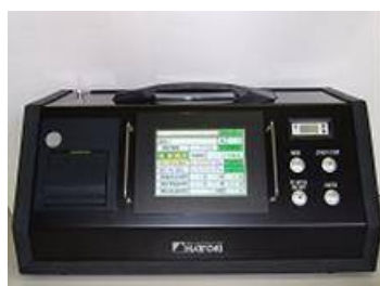
図-36 繊維状粒子自動計測器の例
