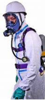
写真Ⅷ－８ 全面形のプレッシャデマンド形 複合式エアラインマスクの例
