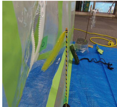
図-32 吹流しによる確認
