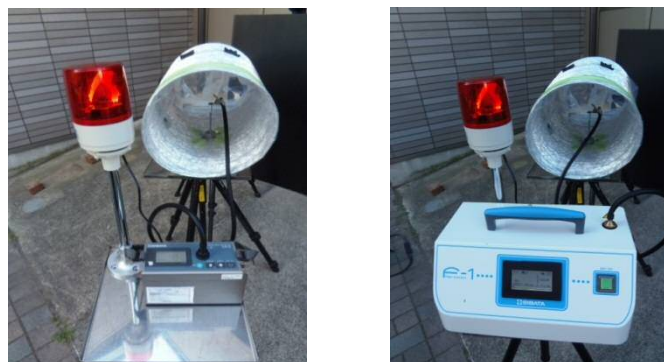
図-40 排気ダクト内の測定時に警告灯を設置した例
