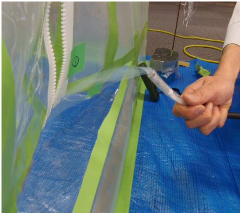
図-31 スモークテスターによる確認
