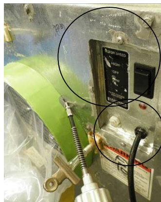
写真－６ 漏れの発生しやすい箇所の例
