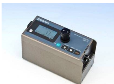
図-34 吸引ポンプ内蔵の粉じん相対濃度計の例
