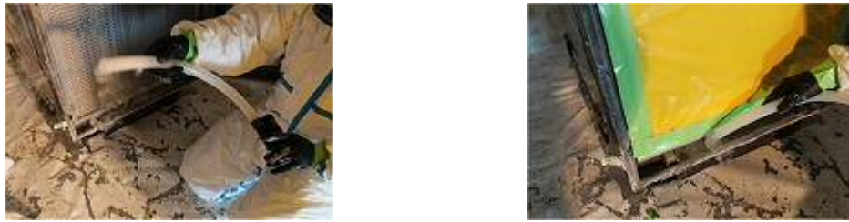
写真VI-12 スモークテスターによる確認
