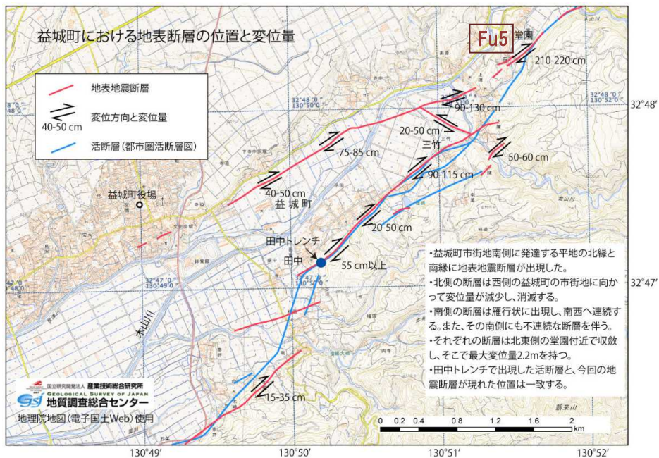
図 2.3.3 益城町における地表断層の位置と変位量
