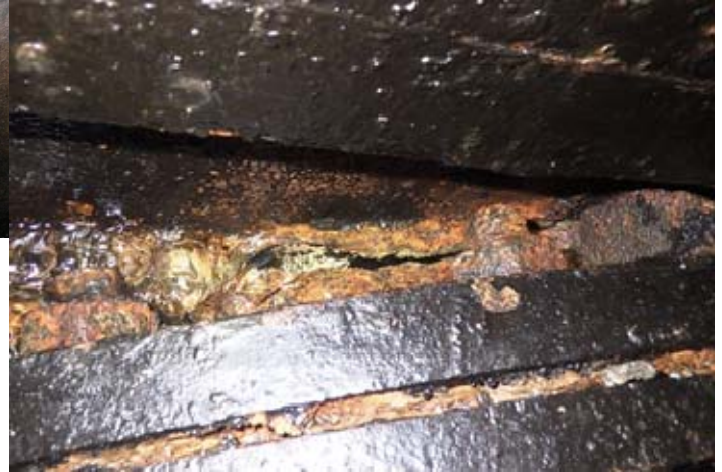
写真 5.2.14 \phi 700 鑄鉄製仕切弁の破損（東区秋津町沼山津, 付属 No. 85）
