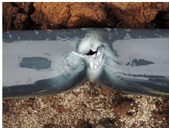
写真 5.5.1 及び写真 5.5.2 VPφ125 被害 (南阿蘇村河陽県道 149 付近)
