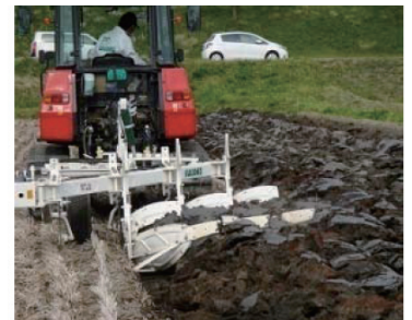
ブ라우(耕起作業機)による反転耕(30cm) 出典:農林水産省
