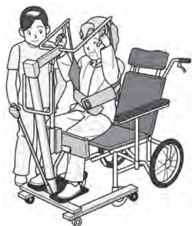
図 7-16 スタンディングマシーン 車椅子からの立位補助
