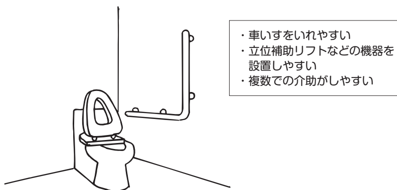
図6-2-15 広い空間が確保されたトイレ
