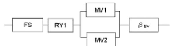
FS：低水位スイッチ、RY1：リレー、MV：遮断弁
