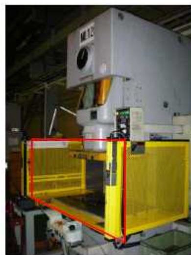
図 2-11 プレス前面のライトカーテン
