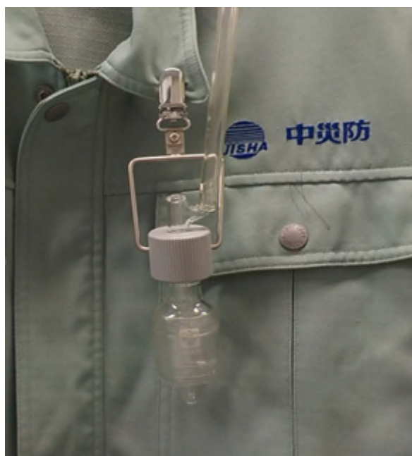
図1 マイクロインピンジャー
