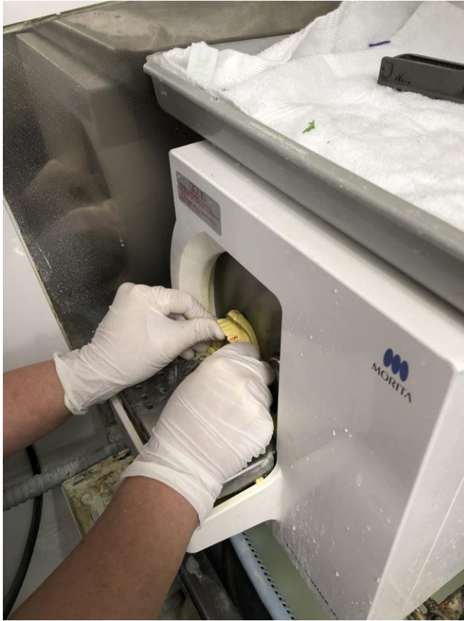
モデルトリマーによる石膏の切削
