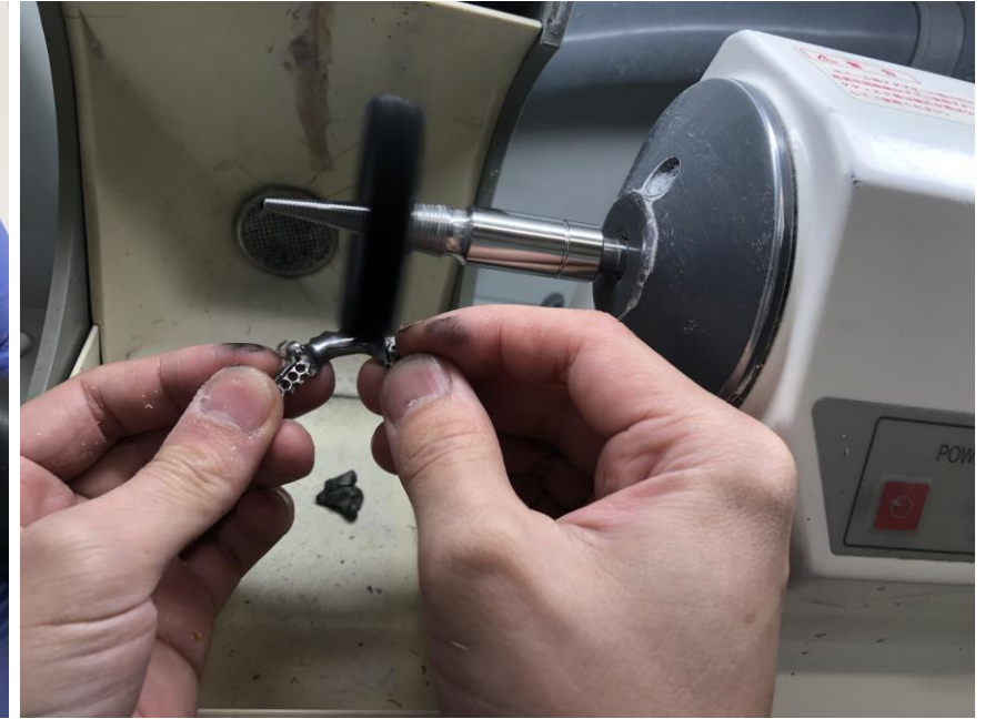
鹿革バフを装着したレーズによる金属フレームの高速研磨
