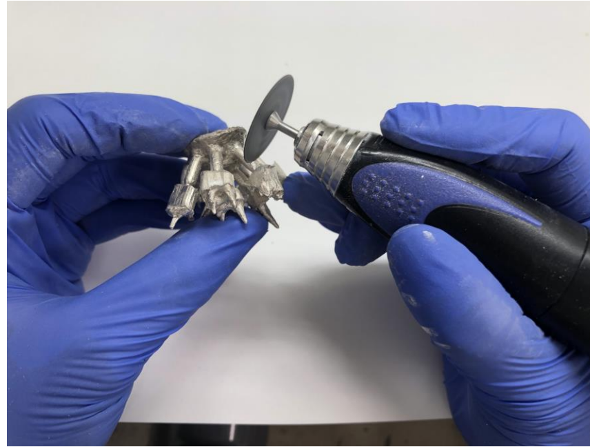
ジスクホイールを装着したハンドピースによる金属スプリングの切断
