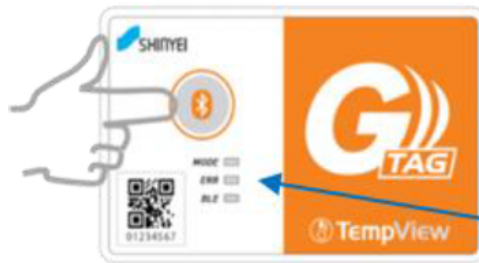
温度測定時の LED 点灯状態(MODE、ERR とも緑色)
