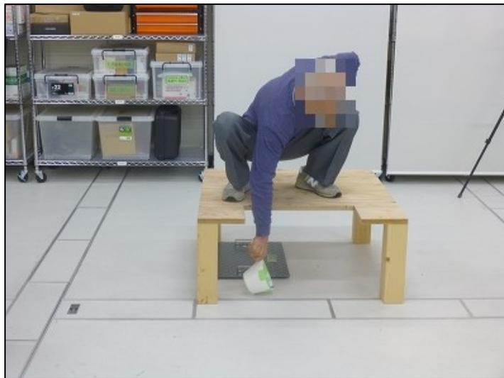
図4-7-3 グリス阻集器の浮上油分を回収する模擬動作（動作③）
