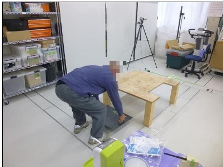
図4-7-4 グリス阻集器の蓋を持ち上げる模擬動作（動作④）
