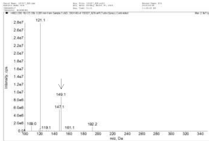
図4-2 アザペロールのプリカーサーイオン m/z 330のプロダクトイオンスペクトル（定性用） スキャン範囲：100～350 m/z 測定条件：ESI+、CV=36、CE=39（CV=コーン電圧、CE=コリジョンエネルギー）
