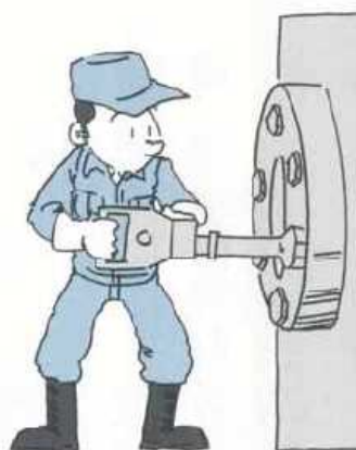
インパクトレンチによる作業
