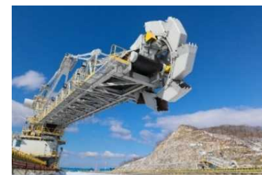
▲ 納入機器例(リクレーマー)
