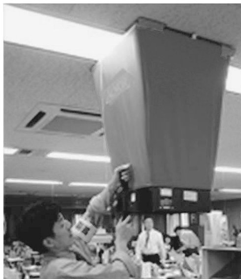
図2 特殊調査（吹き出し風量測定）
