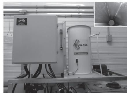
図3 塩素注入装置（右上枠内は装置内部にセットされた次亜塩素酸カルシウムの円形タブレット）
