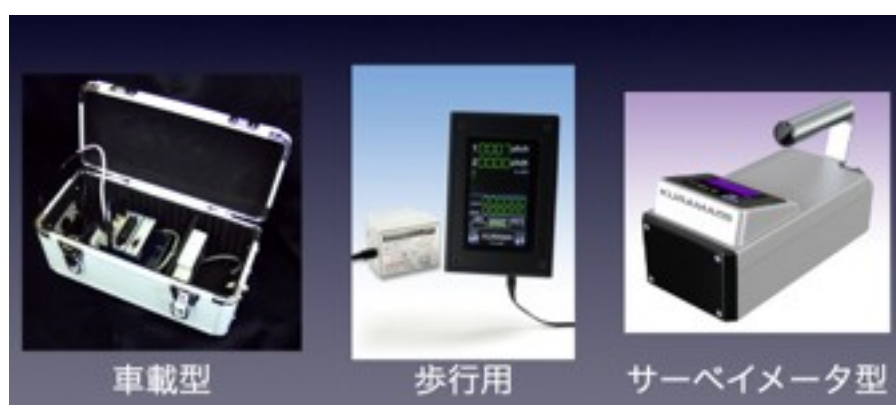
図2 様々な KURAMA-II。車載用(左)の他に、山地や農地などで腰にぶら下げて利用可能な歩行サーベイ用(中)や緊急時対応などを想定したサーベイメータ型(右)などが商品化されている。
