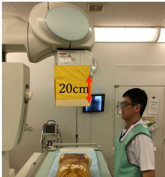
図 6 開発したカーテン（内側：アクリル板、外側：防護シート 0.13mmPb）
