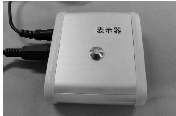
閉口時にライトが無点灯→点灯している状態→初期設定OK
