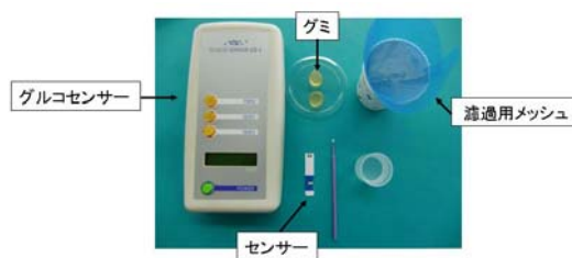
図2. グルコセンサー測定に用いるグミ、メッシュ、センサー等
