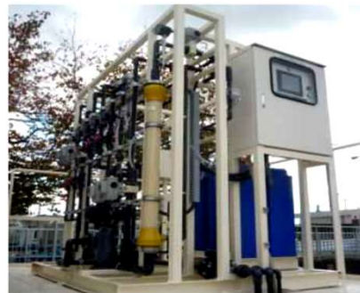
浄水ユニット
