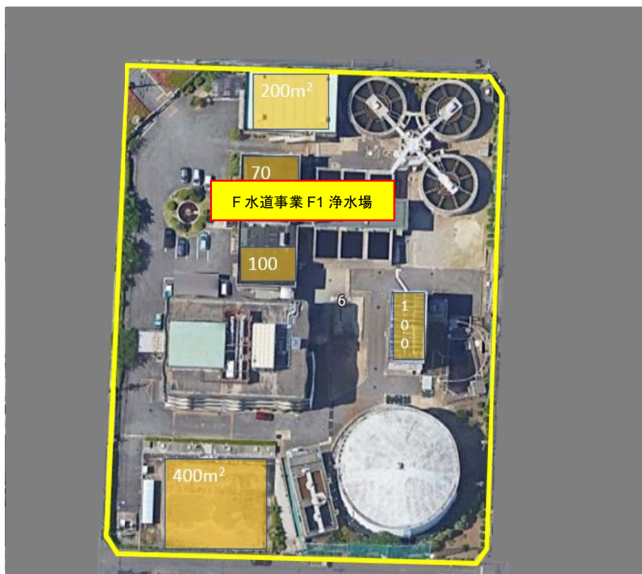
図 4-13 太陽光発電システムの設置可能面積の設定
