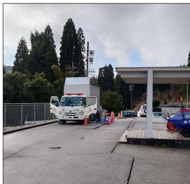
高圧発電機車 （中部電力）
